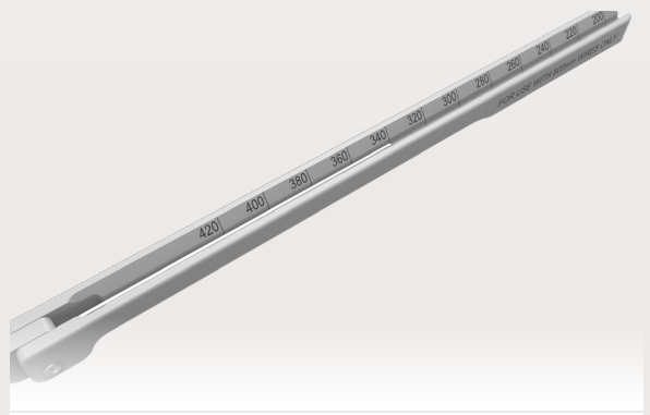
FIGURE 18 : lire la mesure à l'arrière de la broche.
